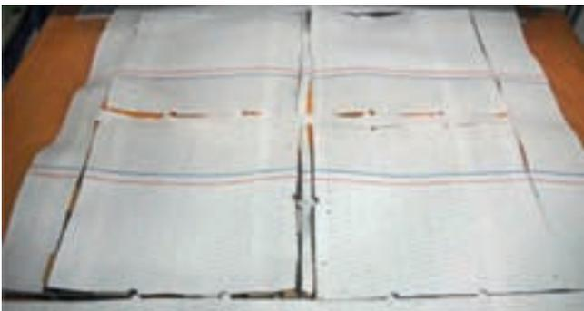
Bild 4 : Beispiel für Materialverschwendung beim Stanzen
