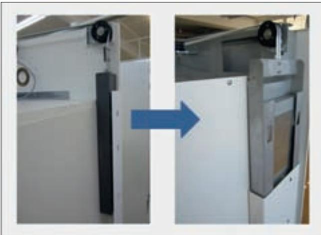
Bild 10: Schiebefensterpositionierung: Alte und neue Lösung im Vergleich
