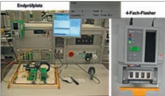
Bild 3: Arbeitsplatz für Prüfung und Endmontage
